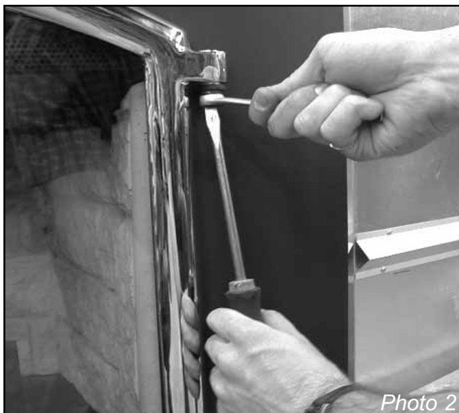
Figure 2: Ajustement des portes
